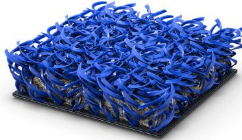
Système de gazon synthétique fabriqué par processus de touffetage en ligne, jauge 3/16" avec 17 touffes/dm, résultant 35.700 touffes/m<sup>2</sup>, avec des fils SHOT XN en bleu de 10 mm de hauteur et 9.000 dtex.
